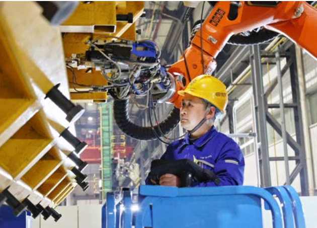
▲ 东方武核技术骨干正在进行金属反射层激光焊接
